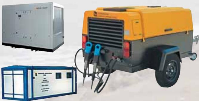
**Блок-контейнеры компрессорные (БКК) и винтовые компрессорные установки типа ДЭН и КВ.**
