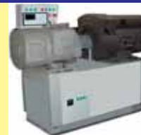
Стенды испытания электромашин постоянного тока подвижного состава
