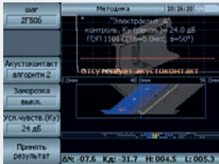
**Рис.4 «Томографик» УД4-ТМ. Сканер «Слайдер». Сигнализация об отсутствии акустиконтакта при диагностике головки рельса.**
