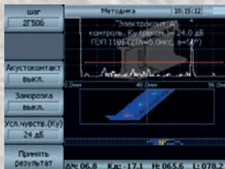
Рис.2 «Томографик» УД4-ТМ. Контроль головки рельса (сбоку) со сканером «Слайдер» 3D проекция.
