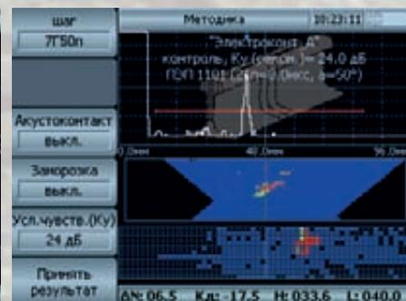
Рис.3 «Томографик» УД4-ТМ. 3D проекция контроля с поверхности головки рельса. Томографическое изображение дефекта в проекции рельса.
