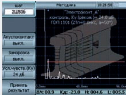
**Рис.5 «Томографик» УД4-ТМ. Контроль шейки рельса.**
