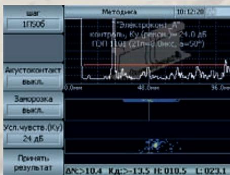
**Рис.7 «Томографик» УД4-ТМ. Контроль подошвы рельса. Перья. Контроль с помощью сканера «Слайдер».**
