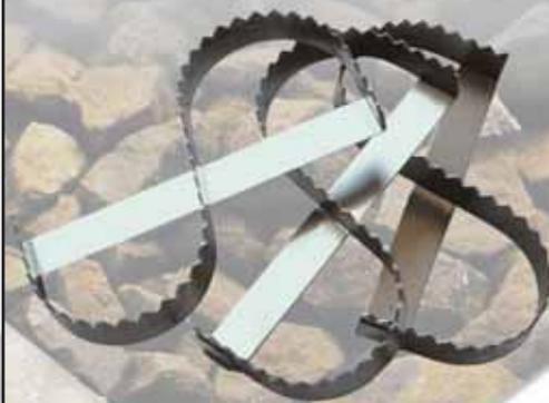
**S-образный торцевой крепежный элемент для деревянных шпал.** используют при ремонте ж/д пути, устанавливая его в места небольшого растрескивания шпал, для предотвращения дальнейшего растрескивания. Использование торцевых крепежных элементов и S-образных скоб позволяет продлить срок службы деревянных шпал на несколько лет.
