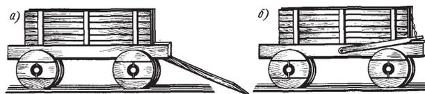
**Первые тормоза рельсового транспорта: а) воздействием на путь; б) с воздействием на колесо**
