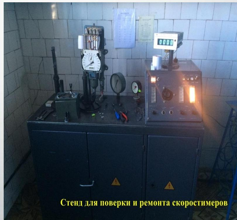
**Стенд для поверки и ремонта скоростиметров**
