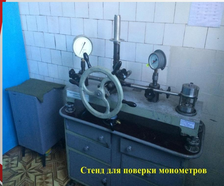
**Стенд для поверки монометров**
