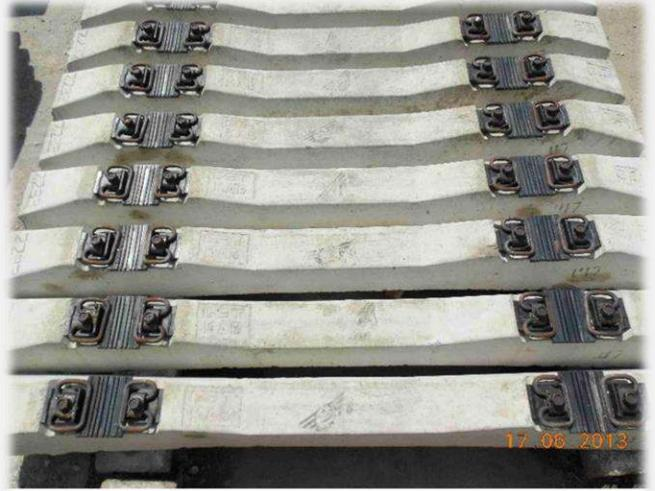
Шпалы железобетонные предварительно напряженные типа ШЗ-ДЧ для челноков на мостах
