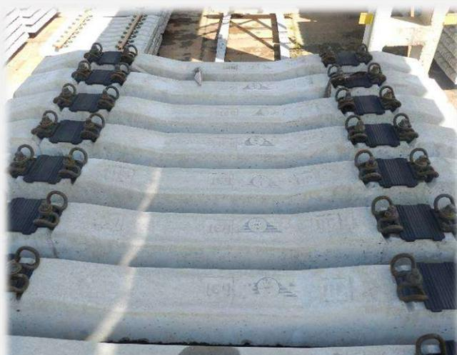
Шпала железобетонная предварительно напряженная под рельсовое скрепление типа W30 «ФОССЛО» (шурупно-дюбельное скрепление)
