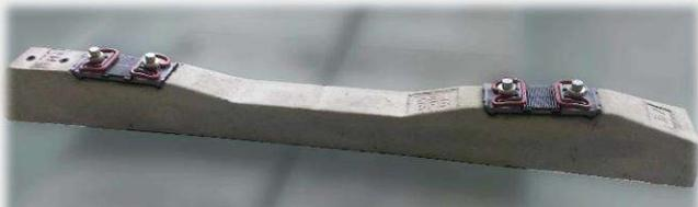
Шпала железобетонная типа III для нераздельного рельсового скрепления с резьбовым прикреплением рельса к шпале (подтип III-ШГ) предназначены для железнодорожных путей с шириной рельсовой колеи 1520 мм, для применения с рельсами типа Р65 и шурупно-дюбельным скреплением типа SBS W SL-1-900-R65.
