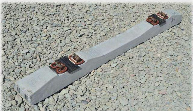
Шпалы железобетонные предварительно напряженные анкерные типа ШС-АРС-К для участков пути в кривых радиусом от 349 м до 300 м включительно, с шириной колеи 1530 мм, 1535 мм, и для переходных кривых с переменной шириной колеи. Для устройства плавного отвода ширины колеи в переходной кривой производят сборку рельсошпальной решетки с использованием специальных регулировочных изоляторов парных комплектов.
