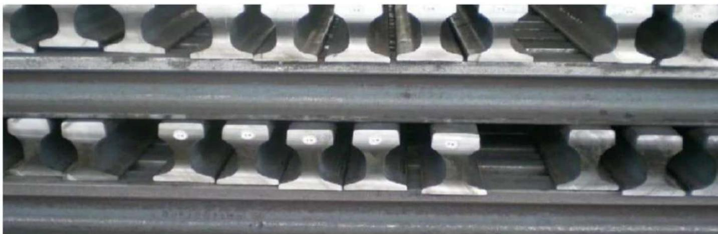
Прижимы для раздельно-разъемного жесткого скрепления
