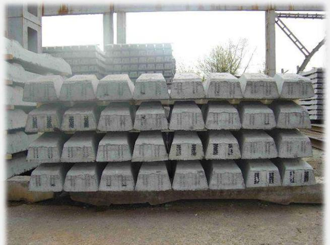
Шпалы железобетонные предварительно напряженные с элементами охранных приспособлений для мостов (тоннелей) под скрепление КБ65
