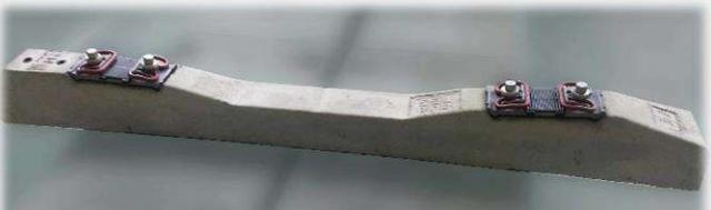
Шпала железобетонная типа III для нераздельного рельсового скрепления с резьбовым прикреплением рельса к шпале подтип III-МБ для путей метрополитена с шириной колеи от 1520 до 1544 с подрельсовыми площадками без подуклонки и с возможностью крепления кронштейна для контактного рельса с шириной колеи.
