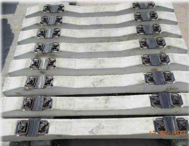
Шпалы железобетонный типа ШЗ-ДК для кривых радиусом менее 350 м. При радиусе кривой от 349 до 300 м следует применять шпалы типоразмера ШЗ-ДК-30, а при радиусе 299 м и менее шпалы типоразмера ШЗ-ДК-35. Для укладки в переходных кривых с переменной шириной рельсовой колеи предназначены шпалы ШЗ-ДК-22, ШЗ-ДК-24, ШЗ-ДК-26, ШЗ-ДК-28.
