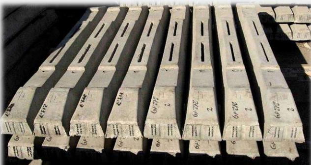
Шпалы железобетонные предварительно напряженные с элементами охранных приспособлений для челноков под скрепление КБ65 (применяется непосредственно на подходах к мостам и тоннелям)
