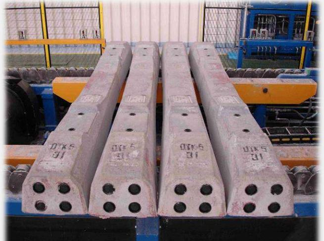
Шпала железобетонная предварительно-напряженная для шурупно-дюбельного скрепления ЖБР-65Ш, арматура 9,6 мм
