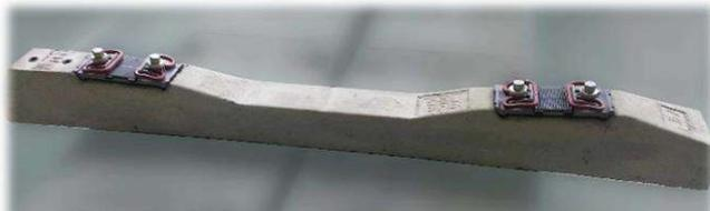
Шпала железобетонная напряженная типа III под рельсовое скрепление типа ЖБР-65Ш (С переменным сечением по длине с повышенным сопротивлением сдвигу для укладки в кривых, высокоскоростных и грузонапряженных участках). Для участков пути в кривых малых радиусов от 340 до 300 м и в переходных кривых предназначены шпалы III -ДБ 4x10 К-22, III -ДБ 4x10 К-24, III -ДБ 4x10 К-26, III -ДБ 4x10 К-28, III -ДБ 4x10 К-30.
