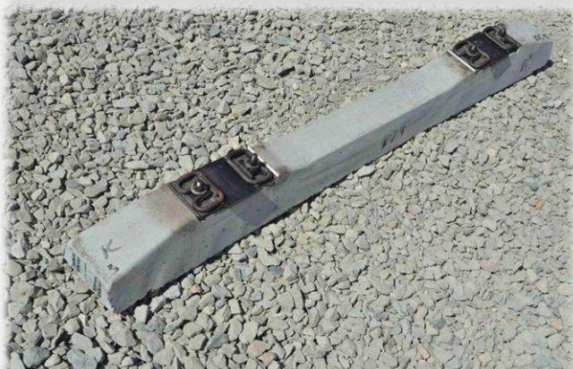
Шпалы железобетонные предварительно напряженные под скрепление ЖБР-65 для кривых участков пути радиусом от 349 м до 300 м с шириной рельсовой колеи в круговых кривых 1530 мм и переходных кривых - 1522, 1524, 1526, 1528 мм и радиусом 299 м и менее с шириной колеи 1535 мм (в комплекте дополнительно шпалы под ширину колеи 1532 мм).
