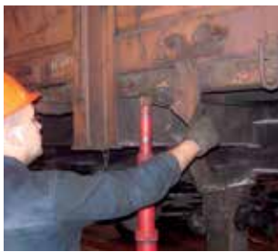
Выправка угла люка и закрытие замка
