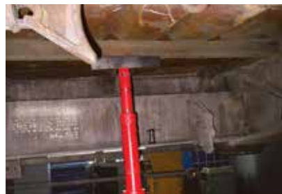
Выправка центрального ребра жесткости люка
