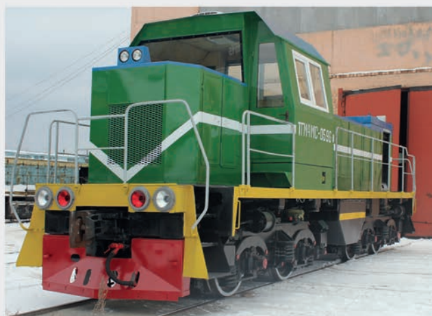
Модернизированный тепловоз ТГМ-4
