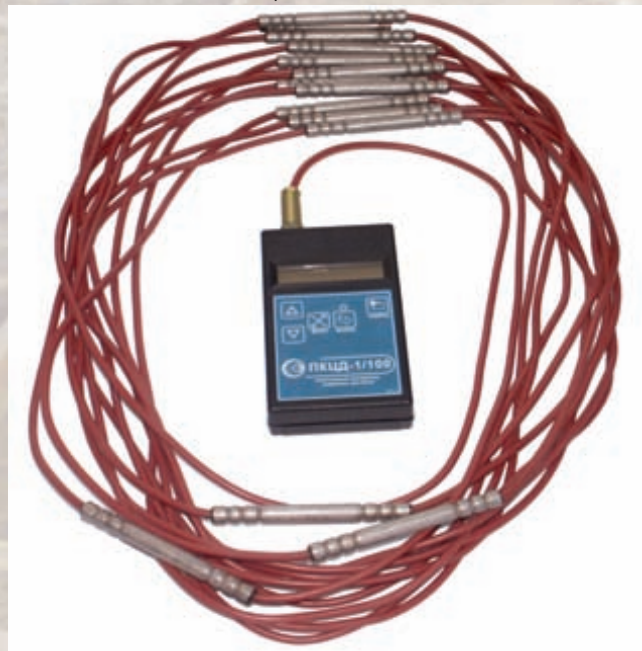
Рис. 1 – Термокоса (МЦДТ 0922) с контроллером (ПКЦД-1/100)
