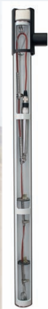
← Рис. 2 – Размещение в скважине термокосу с логгером
