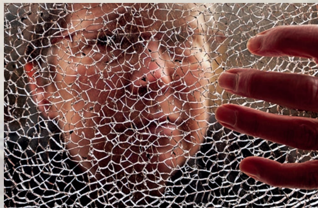
Поврежденное стекло с бронирующей пленкой
