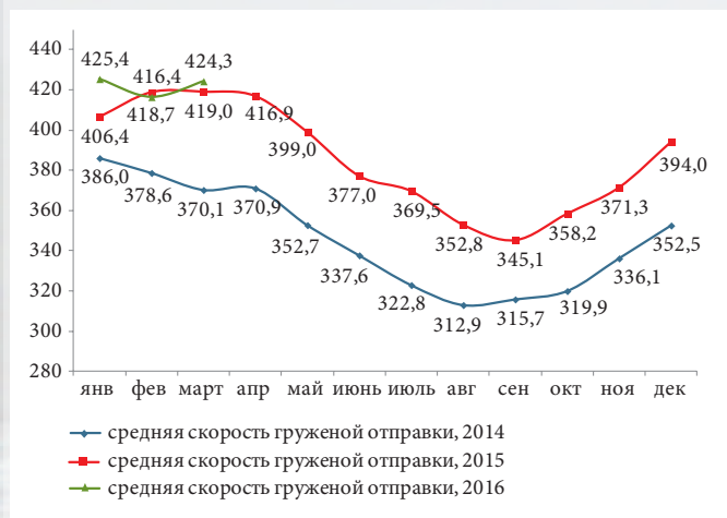
Рисунок 20. Средняя скорость доставки одной грузовой отправки в полувагонах, км/сут. Источник: анализ рабочей группы ИПЕМ
