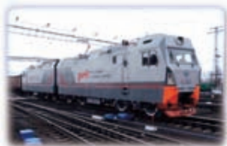
Грузовой электровоз постоянного тока 2ЭС10 «Гранит»
